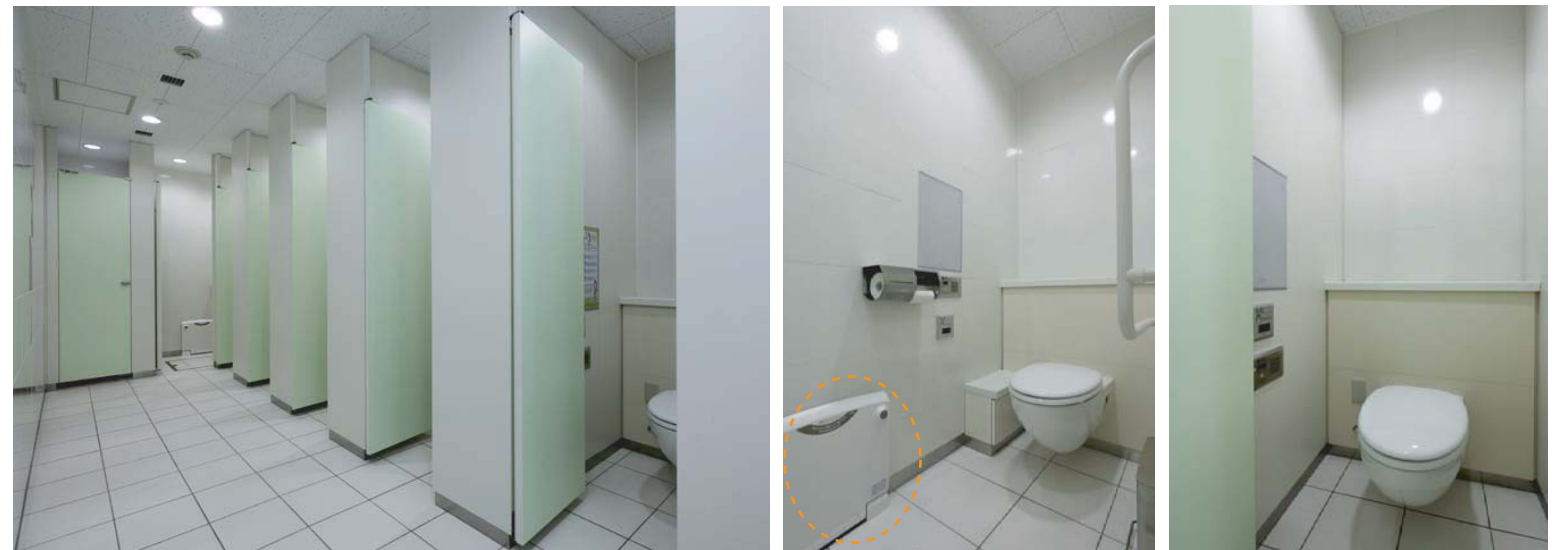
B1階はモザイクタイル・ブース扉にグリーンを採用し、明るくさわやかな印象。最奥のブースにはチェンジングボードを設置し、着替えなどの利用にも配慮がされている。
