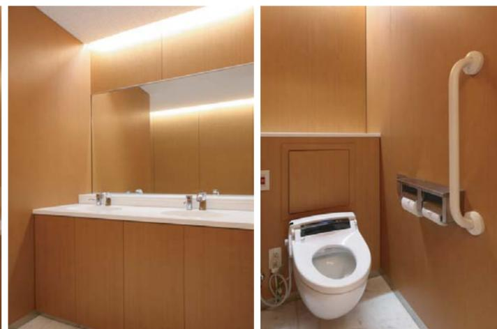
個室感を高めた大便器ブースや、仕切りの設けられたパウダーコーナーなど、落ち着いて使用できる配慮がなされた女性用トイレ。水ハネが少なく優しい洗い心地の泡沫吐水の自動水栓は、従来の2ハンドル水栓と比較して約80%の節水が可能。またバリアフリーにも配慮し、男女とも個室各1ブースずつに手すりが設置された。
