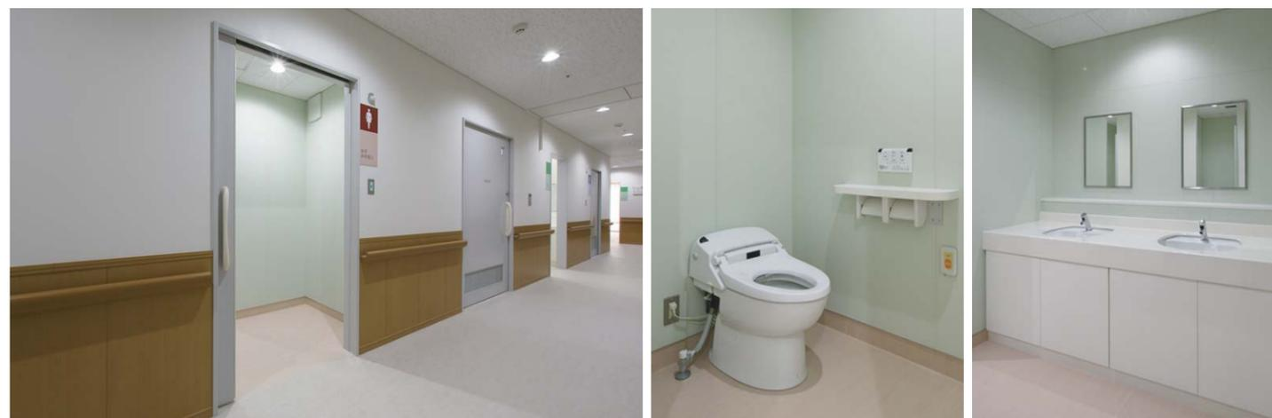
男性用同様、サインと同色に合わせたピンクベースの床色の女性用トイレ。タンクレスタイプのトイレ採用により頭上の空間を確保し、広々とした印象を持つ。メンテナンス性と清掃性に優れた洗面カウンターを採用
