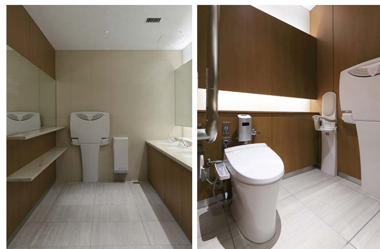
手荷物に配慮しパウダーコーナーのカウンター下に棚を設置。ベビーカーも持ち込める広めブースには幼児用設備機器を備え、ブースの外にもおむつ替えコーナーを設置。ブース扉には空き状況がわかるサインを取り付けスムーズな利用が可能。
