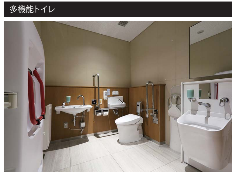
多機能トイレ 車椅子可動域・介助者の動きを考慮し十分なスペースを確保。おむつ替えや着替えが必要な方も安心して利用できるユニバーサルベッドも備えている。
