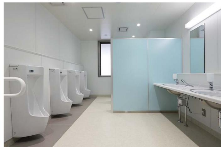
窓からの光を取り入れた明るい室内。小便器下には尿だれに配慮した汚垂石を設置している。また、壁掛タイプの小便器の採用で床の清掃性が向上している。
