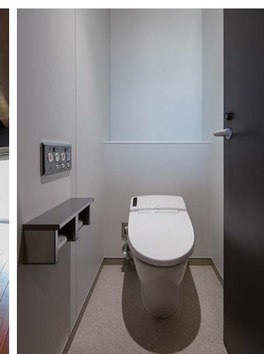
カフェ内には個室タイプのトイレを2つ設置。手洗器を個室の外に設けることで、食事前の手洗いなどの用途でも使えるようになっている。トイレはシンプルな機器とボタンの大きな大型リモコンで誰にでも使いやすい設えになっている。
