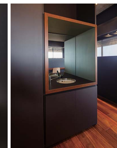
カフェ内には個室タイプのトイレを2つ設置。手洗器を個室の外に設けることで、食事前の手洗いなどの用途でも使えるようになっている。トイレはシンプルな機器とボタンの大きな大型リモコンで誰にでも使いやすい設えになっている。
