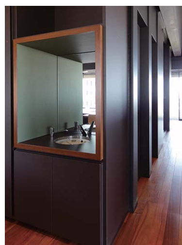
カフェ内には個室タイプのトイレを2つ設置。手洗器を個室の外に設けることで、食事前の手洗いなどの用途でも使えるようになっている。トイレはシンプルな機器とボタンの大きな大型リモコンで誰にでも使いやすい設えになっている。
