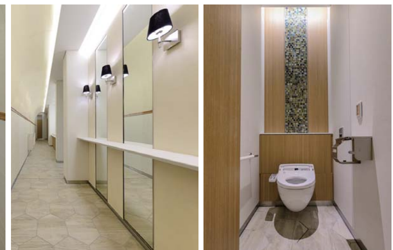
集中利用や混雑緩和に対応するための器具数を確保しながら、さらに全身鏡を備えた独立パウダーコーナーも設けられた女性用トイレ。洗面空間とパウダー空間は奥行きを取らず平行に設置し、通路幅を確保。トイレブース内のライニング部分はカバンなどを置くことができ、手荷物への配慮。
