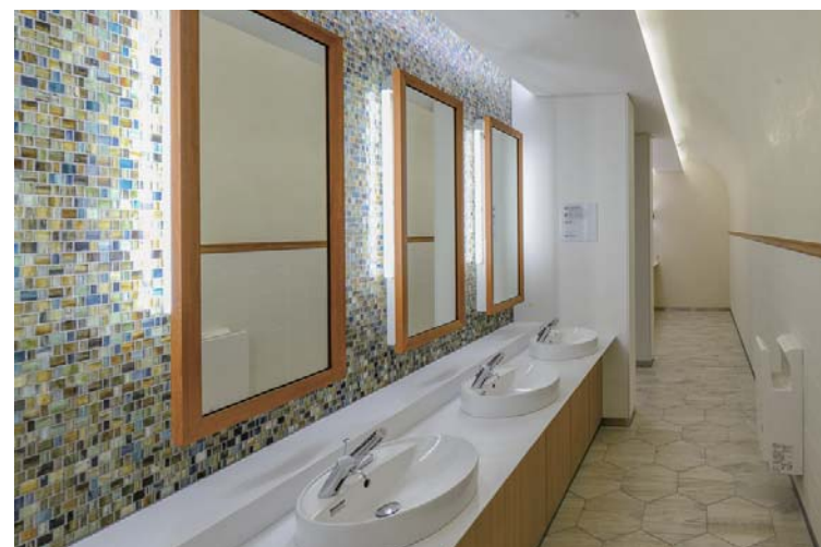
集中利用や混雑緩和に対応するための器具数を確保しながら、さらに全身鏡を備えた独立パウダーコーナーも設けられた女性用トイレ。洗面空間とパウダー空間は奥行きを取らず平行に設置し、通路幅を確保。トイレブース内のライニング部分はカバンなどを置くことができ、手荷物への配慮。
