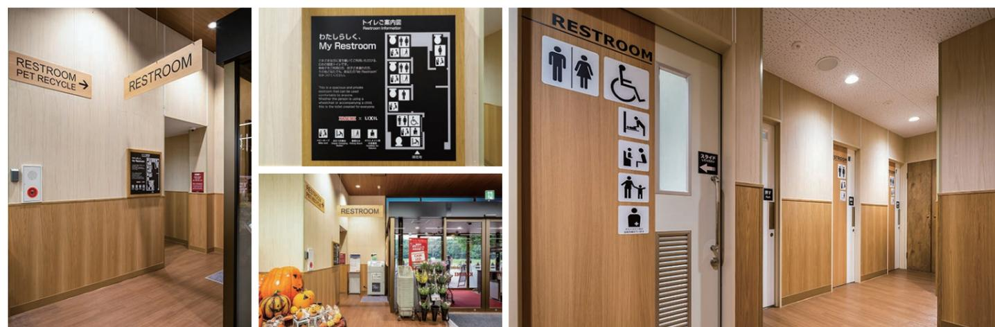
店舗エリアからトイレ利用が見えにくいよう配慮されたレイアウト。入り口のトイレ案内図やそれぞれのトイレの扉には、ピクトサインで室内に設置している器具を表示し、利用者が必要とするトイレを選択しやすくなっている。各個室トイレの扉は対面にせず、視線の合いにくい配置。
