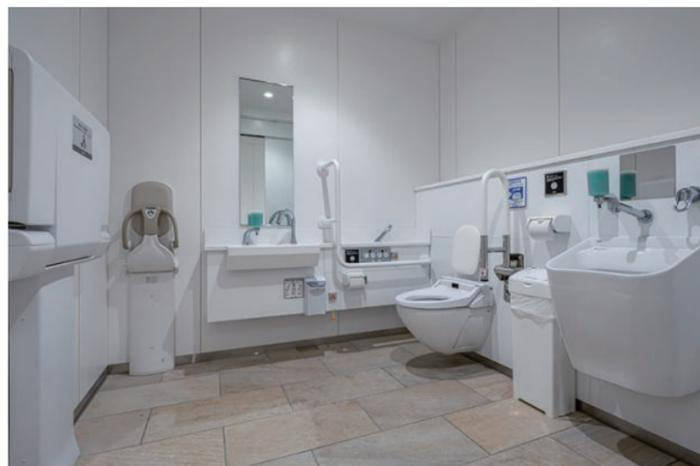
車椅子でも快適に利用できるよう十分な可動域が確保された多機能トイレ。万が一に備え床近くに非常用呼び出しボタンを設置している。
