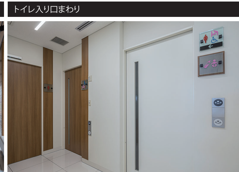
多機能トイレと授乳室には押しボタン式の自動ドアを採用。車椅子ユーザーや乳幼児連れのお客様が入室しやすくなっている。
