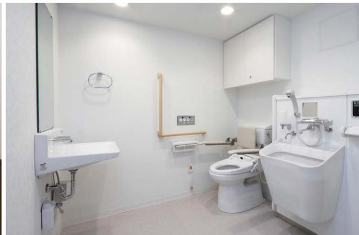
大便器の正面に洗面器を設置し、排泄後の手洗行為までの動線が短くなり利用者と介助者の負担軽減につなげている。
