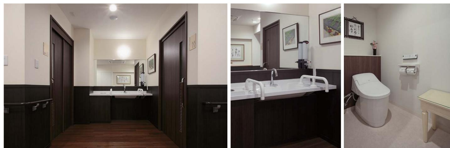
(左:多機能トイレ、右:一般トイレ)多機能トイレと一般トイレの前室には、車椅子でもアプローチできる洗面カウンターが設置されている。多機能トイレは車椅子使用者に配慮した大便器、オストメイトに配慮した流しがスッキリと同じ高さのライニングカウンターに収まった仕様を採用。
