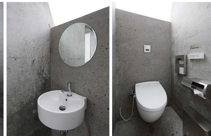
半透明のETFE(熱可塑性フッ素樹脂)膜を張った、北側の屋根全面から光を取り込む明るい室内。夜間は内部照明が街灯の働きを兼ねる。鏡と洗面器を円形にすることで、空間にリズム感が生まれ、空間に柔らかな雰囲気プラス。機器の配管は全て壁に通しているため、床の清掃性に優れている。
