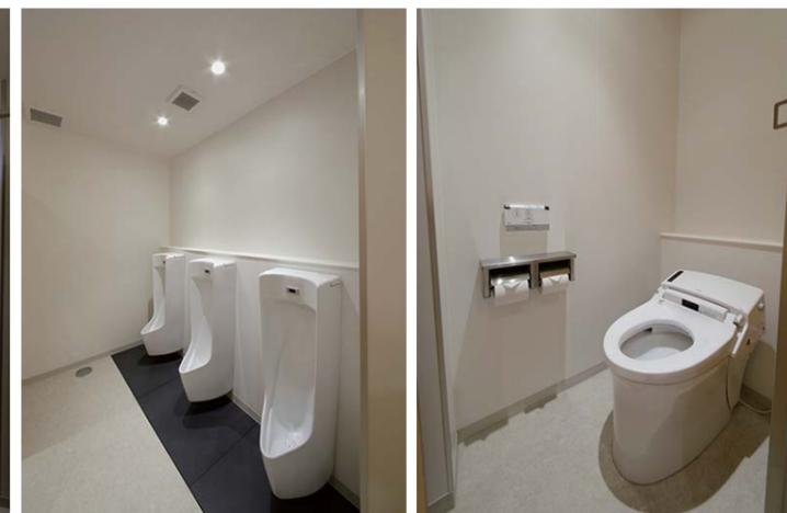
ドライエリアを備えた洗面カウンターを採用。壁付タイプの水栓なので水まわりを清潔に保つことができる。小便器下には尿垂れを考慮し汚垂石を設置。小便器は床のモップ掛けがしやすい壁掛式&凹凸の少ないシンプル形状で清掃性に優れている。
