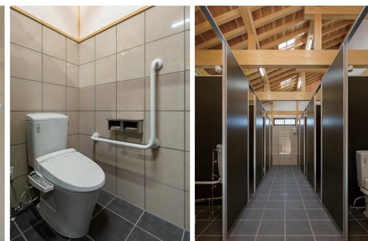
天井を抜くことで頭上にゆとりを持たせたトイレ室内。壁・床ともにタイル張りで清掃性に配慮。壁給排水で床掃除がしやすい洗面カウンターは、フロントパネルを設けずスペースを作ることで、1歩前に近付いて手をあらうことができる。大便器ブースにはシャワートイレを備え快適性を高めている。
