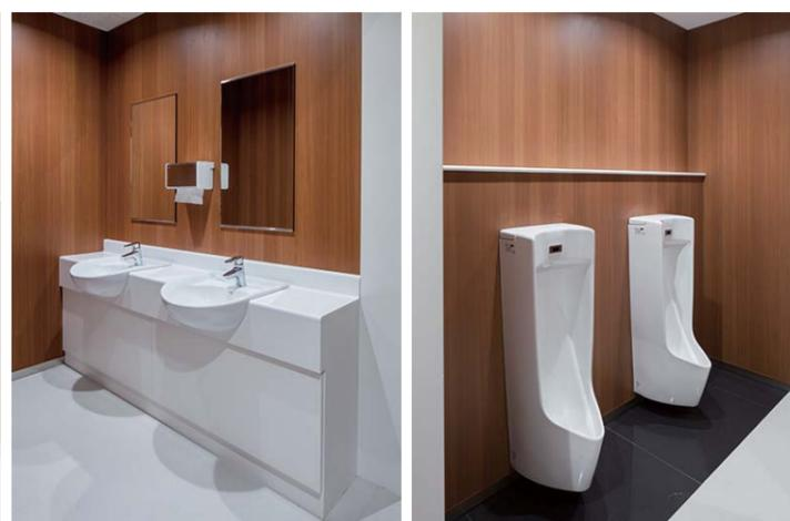
洗面カウンターにはオーバーフロー穴のない洗面器を採用し、衛生面に配慮。小便器は壁掛式で、床の清掃がしやすくなっている。
