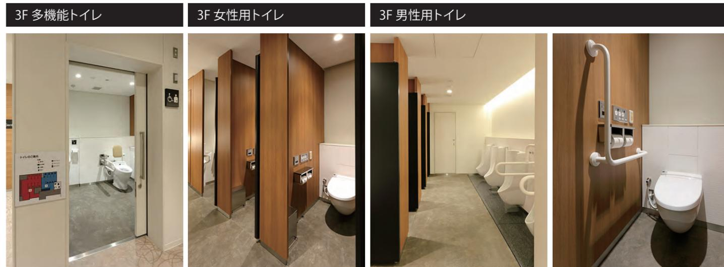
トイレの配置図は車椅子ユーザーにも見やすい高さに表示している。ブース間の壁は天井まで延ばし、個室感を向上させている。壁と扉の色が異なり空室状況が分かりやすくなっているトイレ室内。シャワートイレはボタンが大きくわかりやすい大型リモコンを採用している。
