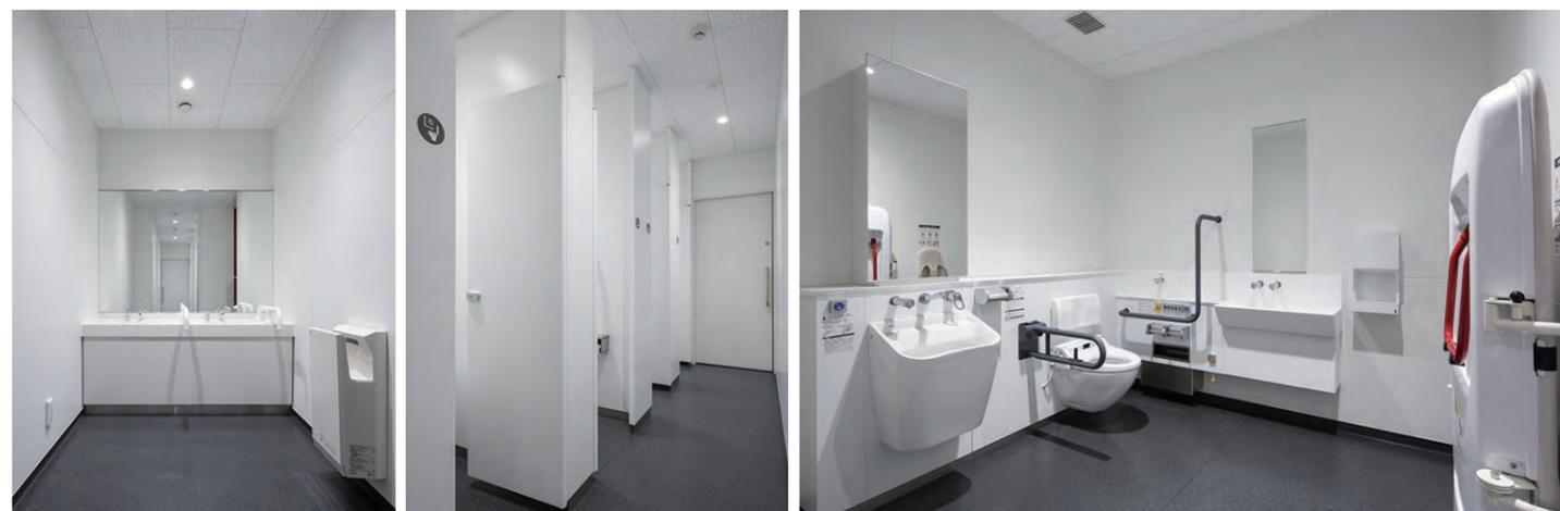
洗面に設置された大型鏡は大人数でも利用しやすい。ブース入り口には左右いずれかの手すりを選択できるようなサインを表示。天井までの扉で安心して利用できる。多様な利用者に配慮した多機能トイレは全フロアに設置。オストメイト対応流しに加えユニバーサルシートも完備している。
