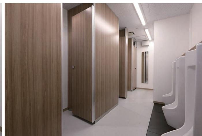
木目がアクセントになっているトイレ空間。小便器は壁掛け式で床の清掃がしやすく、汚垂石を設置することで尿垂れにも配慮。小便器本体に自動洗浄システムを組み込んでいるため、使用者を感知し、自動で洗浄。
