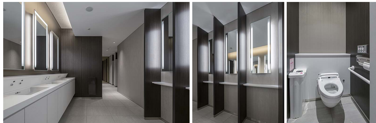
洗面カウンターは水栓をバックガードに埋め込んだシンプルなデザイン。器具が主張しすぎず空間になじんでいる。パウダーコーナーはパーティションで仕切った個別タイプ。隣の視線が気にならないので落ち着いて利用することができる。
