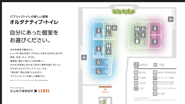
空室表示モニター
