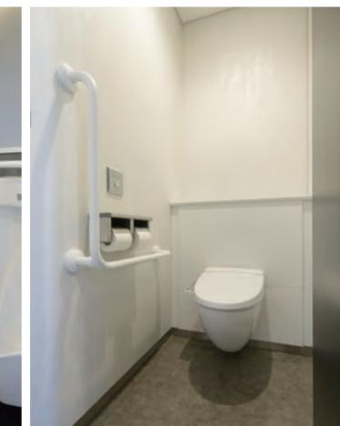
鏡裏や小便器エリアの間接照明が柔らかい雰囲気演出するトイレ室内。窓からの自然光を取り込み、明るい空間になっている。便器は床の清掃性を高める壁掛タイプを採用。また、小便器下には尿垂れを考慮した汚垂石を設置している。
