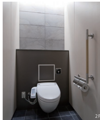
フロアごとに壁・床のタイルやブース色等に変化をつけ、異なるデザインに仕上げている。大便器には立ち座り用に、小便器には身体を支える用に手すりを設置。
