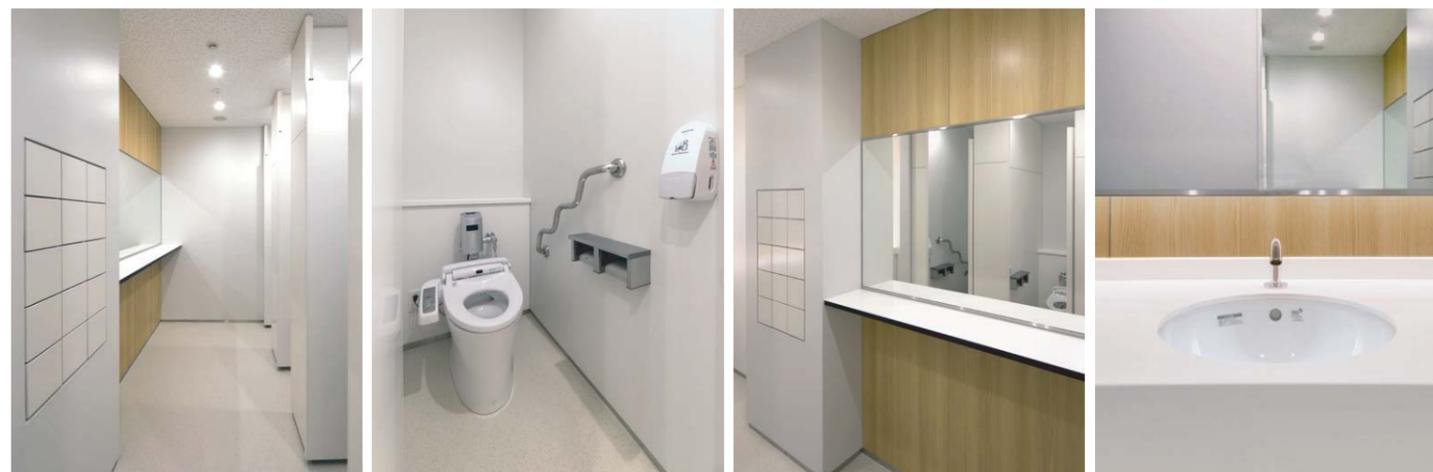
大型鏡を備えたパウダーカウンター、小物ロッカー、擬音装置付きシャワートイレが設置されている女性用トイレ。男女トイレともブース間仕切りは天井まで立ち上げられており、個室感の高いブースに仕上がっている。また、洗面エリアには超小型センサーを内蔵することで美しさと使いやすさを両立させた自動水栓・オートマージョCが採用されている。
