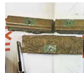
オリジナルの二丁掛レリーフタイルとボーダータイルの採寸とナンバリング
