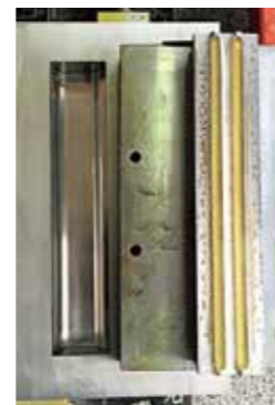
ボーダータイルの金型。断面の厚みに差があることから、圧が均一になる工夫が必要だった
