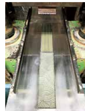
二丁掛レリーフタイルの金型と乾式プレス機
