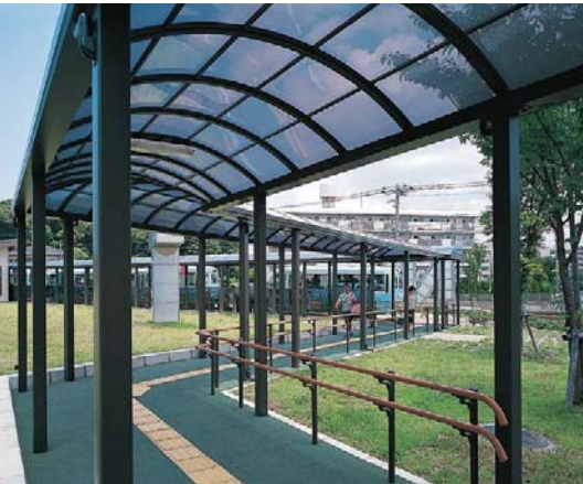
ベンチはシェルターと一体化している可倒式のため、使わないときには通行スペースを広く使えます (春日市ふれあい文化センター バスセンター)
