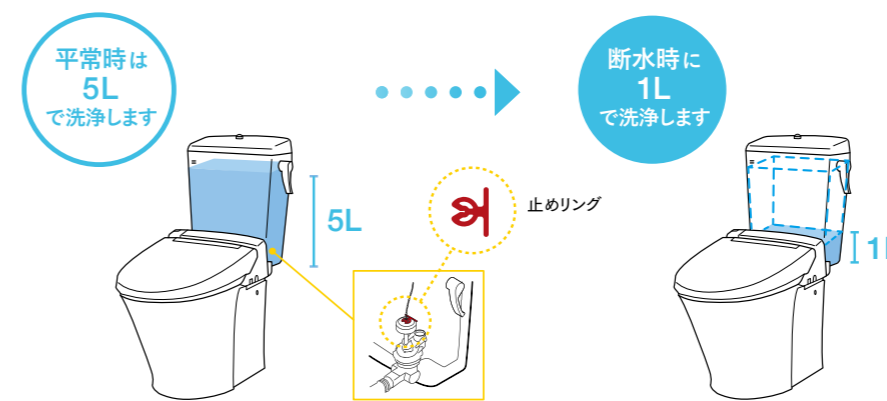
【図3】断水時はタンク内部のリングを抜くことで、1Lモードに切り替わる
