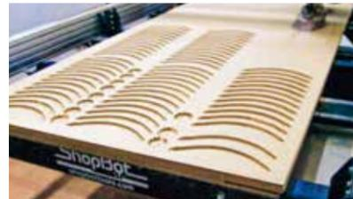
フィリピンのファブラボでのCNCルーターによる加工作業 [写真：鈴木啓/ASA]
