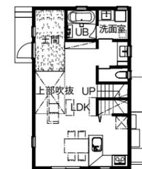
「吹き抜けのある家」1階平面図 S=1:200
