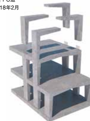
L字形のPCaフレームを中央部で突き合わせ、圧着接合し積層していく [提供: AIG]
